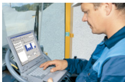
El sistema MATRIS (MACHine TRacking Information System) almacena datos operativos referentes al rendimiento de la máquina. Esta información es muy útil para trabajos de localización de avería y servicio.
