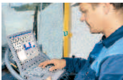
Die gespeicherten Betriebsdaten veranschaulichen das Einsatzverhalten der Maschine. Diese Informationen sind eine wertvolle Unterstützung bei der Fehlersuche und bei Servicemaßnahmen.
