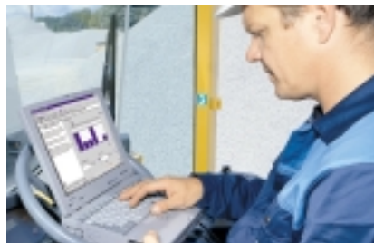
Tallennetut käyttötiedot näyttävät miten kone toimii. Tiedot voidaan käyttää perustana vianetsinnälle ja huoltotoimien suunnittelulle.
