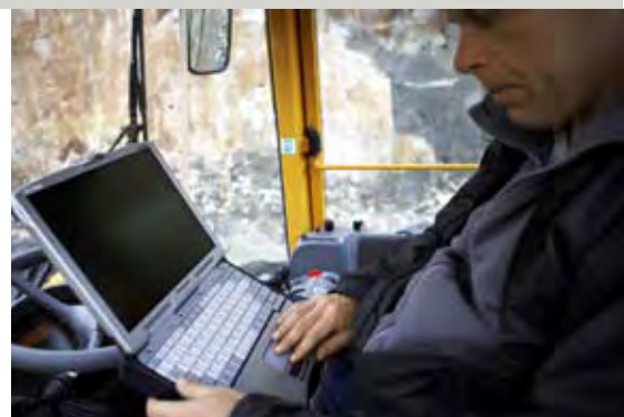
Il sistema MATRIS registra i dati operativi e mostra come la macchina sta lavorando. Tutto ciò fornisce ottime informazioni per la ricerca guasti e per la manutenzione.
