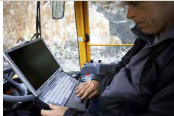
MATRIS almacena datos operativos y muestra cómo está funcionando la máquina. Así se obtiene información valiosa para la localización de averías y el servicio.
