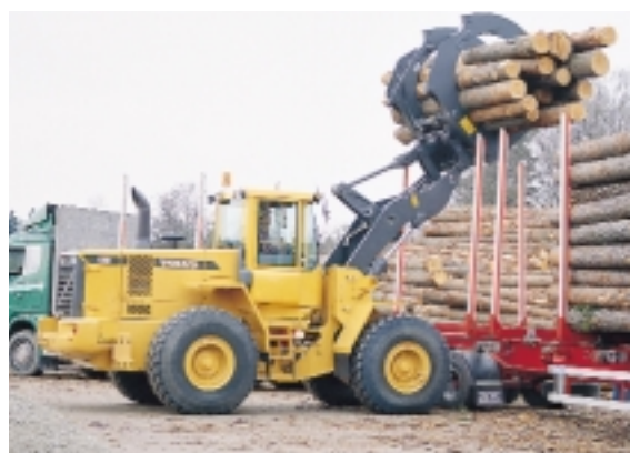
Le TP Linkage trouve sa justification lors de la manutention de grumes. Aucun autre système ne fournit un couple de cavage aussi important sur toute la plage de levage.
