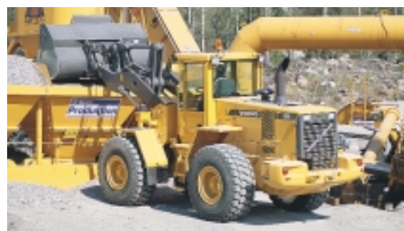
L'une des activités naturelles de la chargeuse : le remplissage d'une trémie.
