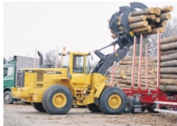
Im Holzschlag treten die Vorzüge des TP-Hubgerüsts besonders deutlich zutage: Nahezu gleichbleibende Reißkraft im gesamten Hubbereich.
