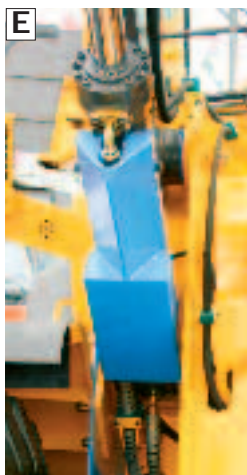
Skydd för cylindrar och rörledningar på lyftarmar Skydd för cylindrar och rörledningar. Slutna konstruktion som förhindrar att material fastnar och skadar/förstör slangar och/eller rör mellan främre ramen och cylindrar på lyftarmarna. Slangskydd i form av stålspiraler och en skyddsplåt används för att täcka slangförbindelser mellan lyftarmarnas cylindrar och manöverventilen. (L60E–L220E)
