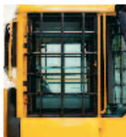
Skyddsgaller för sidofönster och bakfönster Skyddar både sido- och bakfönstren. Sidofönstrets skyddsgaller är försedda med gångjärn och kan lätt fällas ner för enkel rengöring och underhåll. Bakfönstrets skyddsgaller demonteras lätt med hjälp av två låsanordningar avnabbkopplingstyp. (L60E–L220E)
