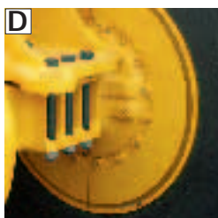
Hjul/axeltätningsskydd Förhindrar att material lindas runt axlarna och skadar axeltätningarna under körning. (L60E–L220E)
