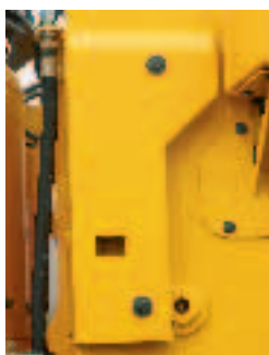
Skyddsplåt för smörjledningar Plåt som skyddar utsatta smörjledningar och smörjniplar. (L70E–L220E)
