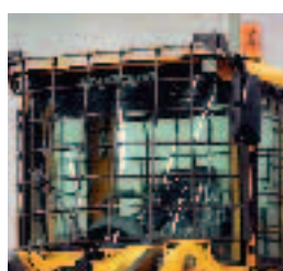
Skyddsgaller för vindruta Skyddar både glaset och föraren mot fallande föremål. Specialkonstruerat för att minimera glasbrott med bibehållen optimerad sikt. (L60E–L220E)
