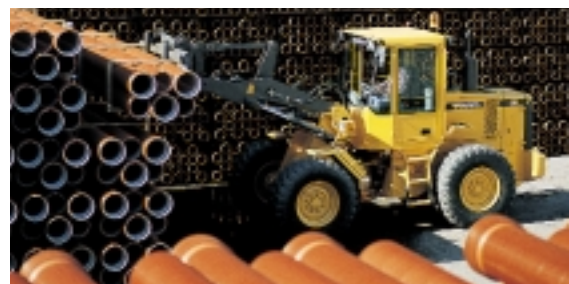
Le système TP Linkage facilite le travail à portée maximale et les mouvements parallèles, même en hauteur.
