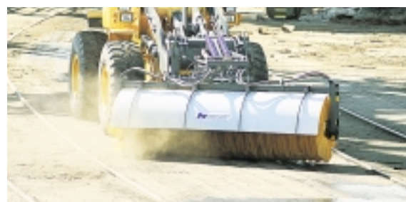
La transmission hydrostatique de la L50D et sa fonction de « vitesse rampante »** permettent d'acheminer le maximum de puissance vers les accessoires tout en opérant à très faible vitesse.
