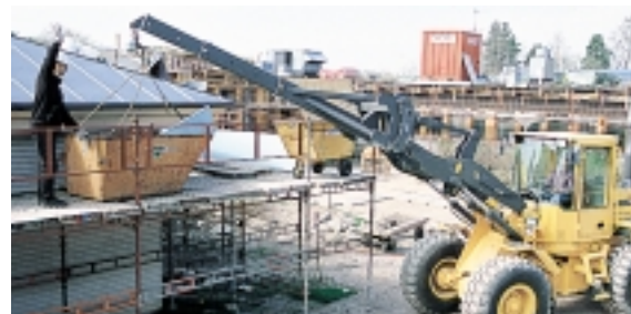
Le bras de manutention Volvo est particulièrement bien adapté au couple de cavage élevé et à la précision des commandes inhérents au TP-Linkage.
