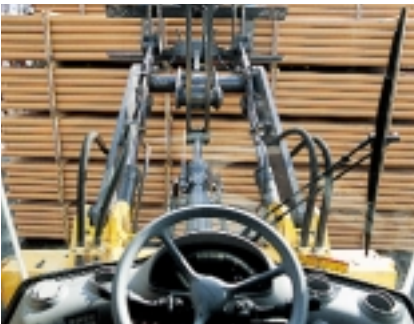
Mit dem besseren Durchblick im Bereich Geräteträger und Anlenkung läßt sich der Stapelvorsatz zielgenau manövrieren.
