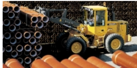
Auch hohe Stapel stellen für das TP-Hubgerüst mit seiner großen Reichweite und ausgezeichneten Parallelführung kein Problem dar.
