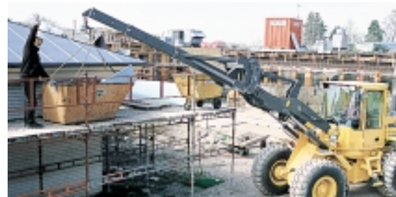
Der Volvo-Ausleger für den Materialumschlag profitiert von der überlegenen Reißkraft und Feinsteuerbarkeit des TP-Systems.
