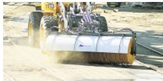
Mit Hydrostatantrieb und Inch-Funktion** maximiert der L50D die Leistungsübertragung zu den Anbaugeräten bei niedriger Motordrehzahl.
