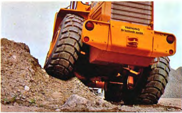
Gran oscilación del eje trasero – total 30°.
