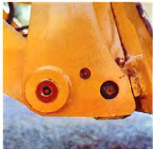
Los bulones de la cuchara están muy bien dimensionados para soportar con amplio margen los esfuerzos a que se ven sometidos en trabajos duros.
