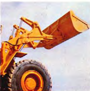
La unidad de carga es de construcción muy robusta y de material de primerísima calidad. Los brazos elevadores están fijados con gran distancia entre sí al bastidor de gran rigidez.
