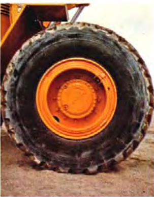
Las grandes ruedas proporcionan al 846 una marcha estable, facilidad de avance y flotabilidad por terrenos difíciles.
