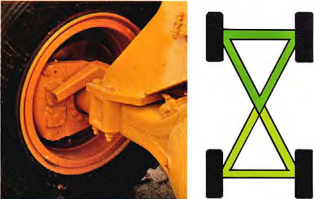
Para máxima seguridad el sistema de frenos está formado por dos circuitos. Discos de freno bien protegidos en las cuatro ruedas y grandes superficies de fricción.
