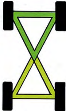
Jarrujärjestelmä jakaantuu kahteen piiriin turvallisuuden varmistamiseksi. Kaikissa pyörissä on hyvin suojatut ja suuripinta-alaiset levyjarrut.
