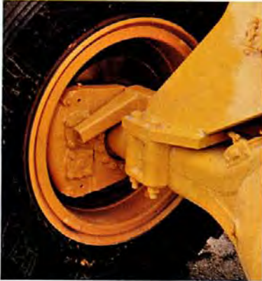
Jarrujärjestelmä jakaantuu kahteen piiriin turvallisuuden varmistamiseksi. Kaikissa pyörissä on hyvin suojatut ja suuripinta-alaiset levyjarrut.
