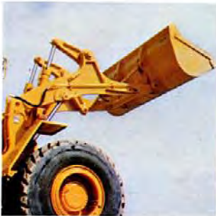
Kuormain on vankkatekoinen ja tehty ensiluokkaisesta materiaalista. Nostovarsien kiinnitys vääntöjäykkään runkoon on erityisen leveä.
