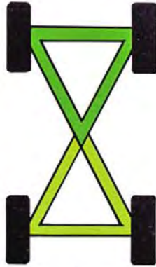
Bremsesystemet er opbygget i to-kredssystem, som giver større sikkerhed. Velbeskyttede skivebremser med store bremsearealer.
