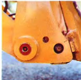
Skovlens ledtap er specielt kraftigt dimensioneret for med god marginal at klare hård kørsel.
