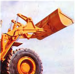
Læsseaggregatet er kraftigt opbygget af stærk materiale. Løftearmene har en bred fæstning i den vridsikre ramme.
