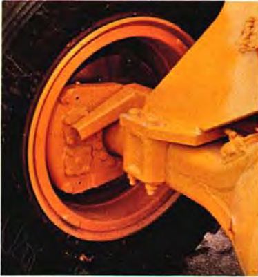
Bremsesystemet er opbygget i to-kredssystem, som giver større sikkerhed. Velbeskyttede skivebremser med store bremsearealer.
