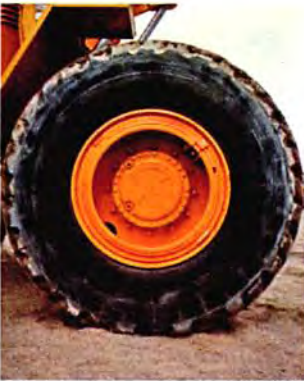
Stora hjul ger 846 stabil gång, god framkomlighet och bärighet vid dåliga markförhållanden.
