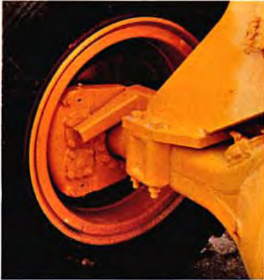
Bromssystemet är uppbyggt i två kretsar för högsta säkerhet. Väl skyddade skivbromsar runt om med stora friktionsytor.
