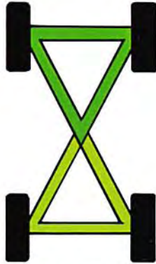
Bromssystemet är uppbyggt i två kretsar för högsta säkerhet. Väl skyddade skivbromsar runt om med stora friktionsytor.
