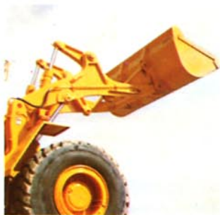
Lastaggregatet är kraftigt uppbyggt i en hög materialkvalitet. Lyftarmarna har en bred infästning i den vridstyva ramen.
