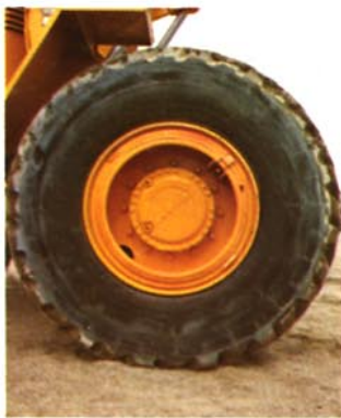
Stora hjul ger 846 stabil gång, god framkomlighet och bärighet vid dåliga markförhållanden.
