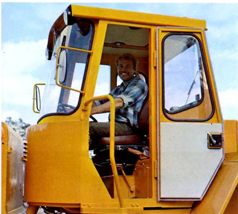
I den helsvetsade hytten sitter föraren säkert och har en utomordentlig runt-om sikt.
