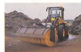
Sopmaskin Sopmaskin för inkoppling till redskapsfästet. Kan utrustas med vattentank och spridarmstycken.
