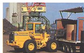
Hydraulisk klämngaffel Utrustning för effektiv hantering av t. ex. balar och rullar.
