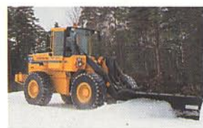
Diagonalblad För snöröjning. Hydrauliskt ställbart.
