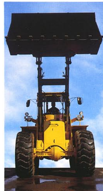
Den symmetriska infästningen av hydraulcylindrarna ger god driftsäkerhet och extra bra sikt genom lyftaggregatet.
