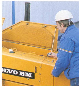
Kylarkåpan kan snabbt och enkelt fällas ut för t ex rengöring.
