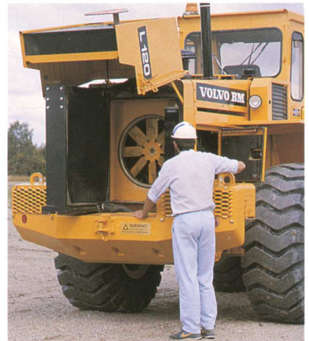
Rejåla luckor och plattformar gör det lätt och säkert att utföra inspektioner.
