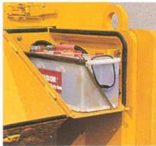
Lätt åtkomlig och skyddad placerad batterilåda med fällbart lock.
