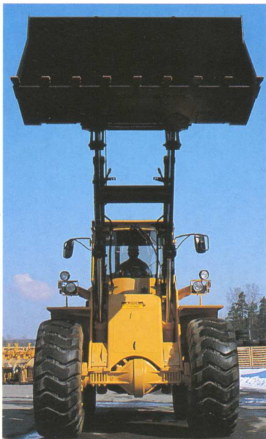
Den symmetriska infästningen av hydraulcylindrarna ger god driftsäkerhet och extra bra sikt genom lyftaggregatet.
