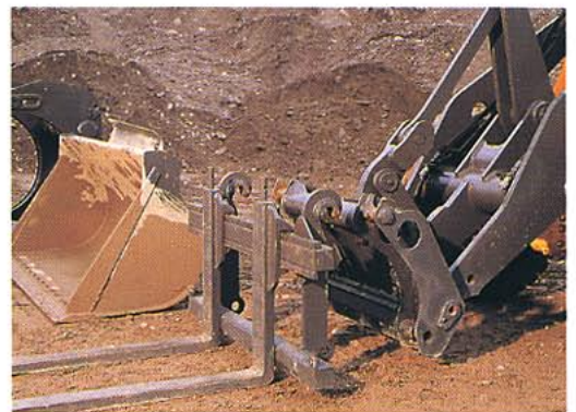
Tack vare det hydrauliska redskapsfästet kan du ansluta Volvo BM originalredskap på några sekunder.
