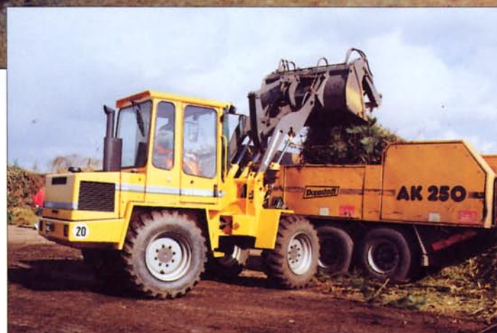
Godet à végétaux à abattant hydraulique.
