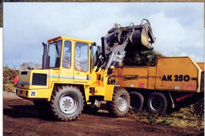
Spezielschaufel mit hydraulischem Greifer
