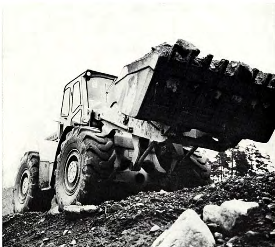
Skopvinkeln tillåter maximal råge utan spill.
