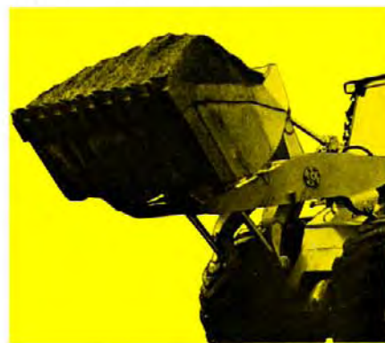
Skopvinkeln tillåter maximal råge utan spill.
