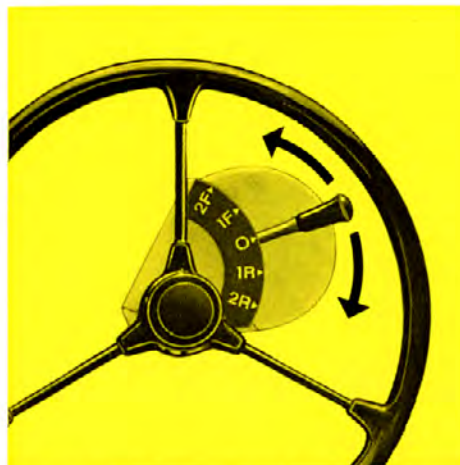
Pas de pédale de débrayage — un simple sélecteur de vitesses, commodément placé sous le volant.
