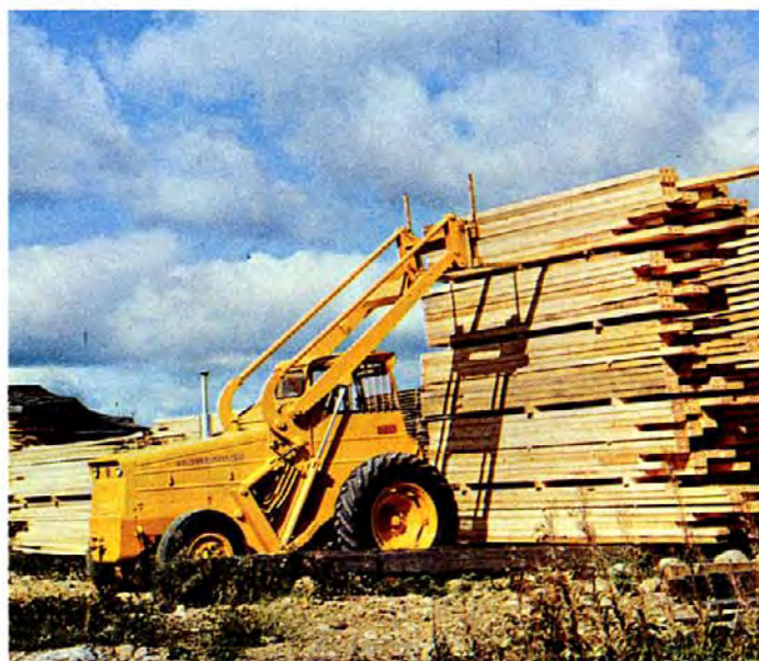
La grande altezza di sollevamento costituisce un enorme vantaggio nei depositi di legname.
