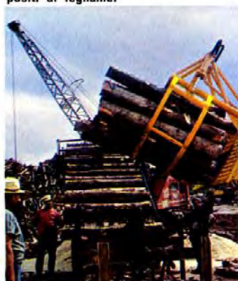
Pinza regolabile per lo smistamento di legname minuto.
