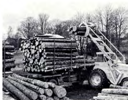
La grande altezza di sollevamento consente di caricare agevolmente autocarri dalle sponde molto alte.
