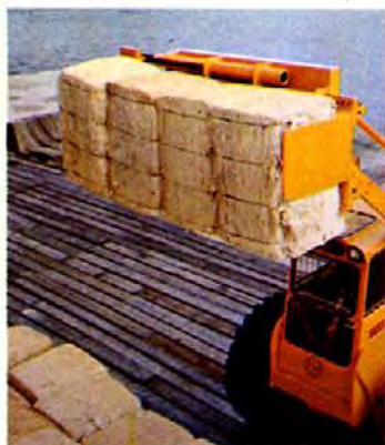
Pinza idraulica per lo smistamento di balle di pasta di legno.
