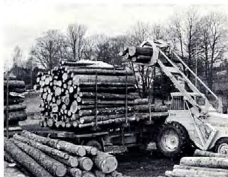
La gran altura de elevación posibilita la carga efectiva de camiones con laterales altos.
