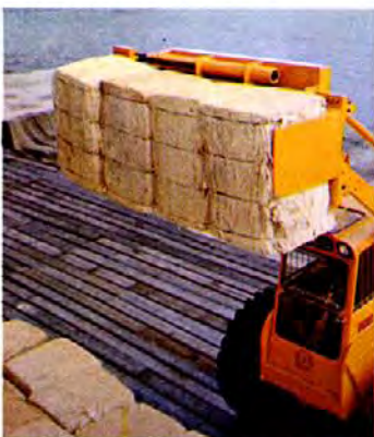
Horquilla de apriete hidráulica para la manipulación de fardos de pasta de papel.
