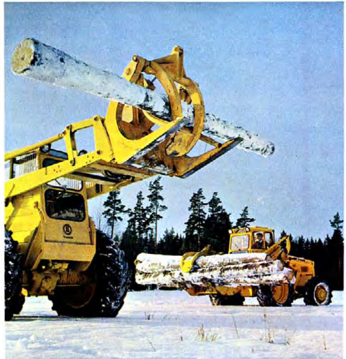
El agarre seguro tanto de un solo tronco como de una carga completa.
