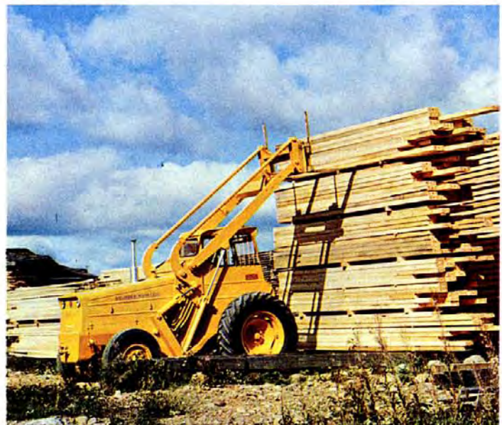
La gran altura de elevación es una importante ventaja en los almacenes de madera.
