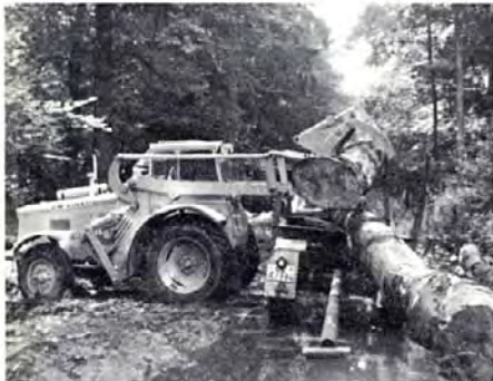
LM 620 beim Aufladen von ganzen Buchenstämmen in Deutschland.
