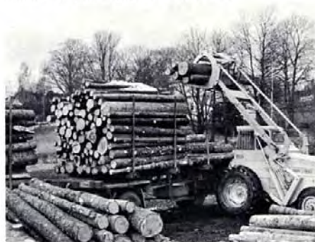
La grande hauteur de levage permet le chargement rationnel des camions à ranchers élevés.
