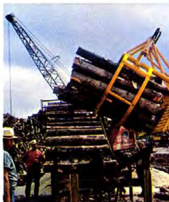
Pince réglable pour la manutention des rondins de pâte à papier.
