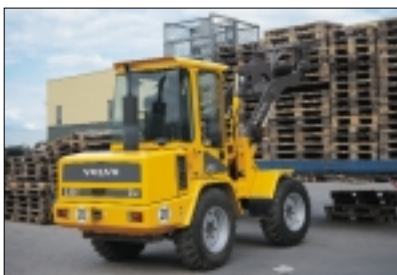
Z-Kinematik - die robuste Vielweck-Kinematik mit den hohen Reiß- und Hubkräften. Kraftvoll in Verladung und Produktion.
