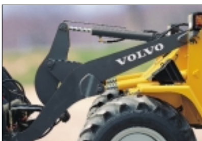
Z-Kinematik - die robuste Vielweck-Kinematik mit den hohen Reiß- und Hubkräften. Kraftvoll in Verladung und Produktion.
