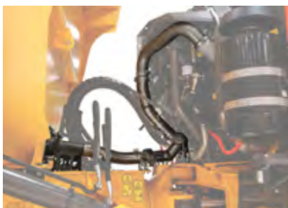
Обогрев кузова с помощью выхлопных газов
